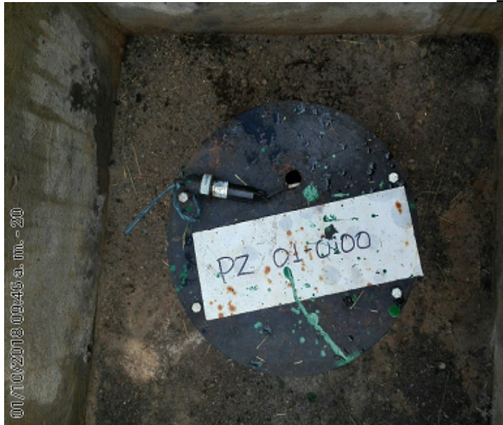
Fotografía 4. Vista del sensor de nivel con referencia AS6060-1143064.
