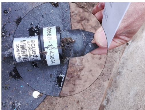
Fotografía 3. Diver instalado en el pozo.
