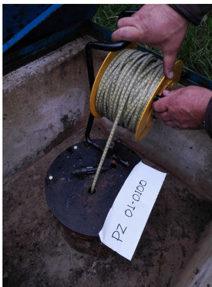
Fotografía 2. Medición de niveles en la boca del pozo. (7.7m nivel estático).
